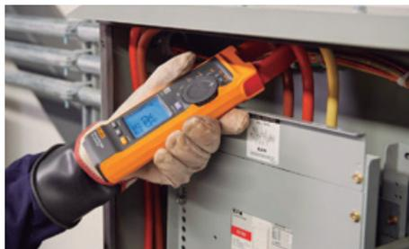
A Fluke lançou a pinça amperimétrica Fluke 393 FC para realizar trabalhos de manutenção e instalação em ambientes com tensões DC até 1500 V. Esta solução é a única disponível no mercado, com TRUE RMS e classificação CAT III 1500 V. A sua classificação proporciona uma segurança incomparável com a classificação CAT III 1500 V / CAT IV 600 V, bem como a robustez de que necessita para a utilização em ambientes exteriores e poeirentos.
