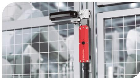
Existem máquinas, que mesmo depois de desligadas, continuam com determinadas áreas ativas em que o operador da máquina está impedido de aceder a estas áreas até que o movimento perigoso fique completamente parado. Por exemplo, na descida lenta das lâminas de uma serra ou na paragem de uma grande massa de um volante de uma máquina.
