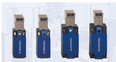
A Schmersal lançou no mercado 4 novos interruptores de segurança eletromecânicos com atuadores separados: os interruptores AZ215 / AZ216 e AZ315 / AZ316 encarregam-se de monitorizar a posição de portas de proteção de deslocação lateral ou giratória. Distinguem-se por uma característica extraordinária, que é a cabeça giratória do atuador em zinco fundido sob pressão que pode ser facilmente rodada em 90° antes da montagem. Dessa maneira, a cabeça
