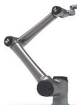
Este *cobot* destaca-se por ser o modelo mais comprido da sua gama e por possuir a maior capacidade de carga, tornando-o numa ferramenta essencial para diversas indústrias e aplicações. O TM25S é ideal para uma vasta gama de tarefas, incluindo *Pick&Place*, manuseamento de máquinas, embalagem em alta velocidade e paletização. Estas aplicações são cruciais em ambientes industriais que requerem eficiência e precisão.
