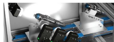
Os processos de verificação da presença de componentes, da verificação da correta posição de montagem ou mesmo na verificação se as peças estão ou não danificadas, são realizados com elevada precisão e eficácia. O fabricante Di-Soric tem uma gama ampla de sensores, de diferentes tecnologias, com características inovadoras. Para mais informações consulte a equipa comercial da Alpha Engenharia ou visite o *website* em [www.alphaengenharia.pt/PR60](http://www.alphaengenharia.pt/PR60). 📍
